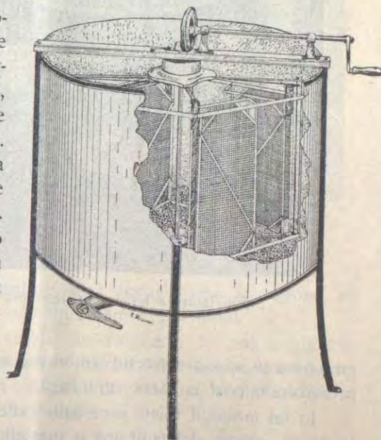
Smielatore automatico "Regina," per telaini Dadant. Con esso, si voltano automaticamente i favi all'interno, senza bisogno d'estrarli.
